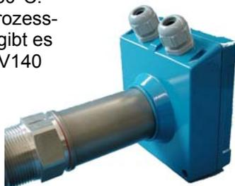
Damit die maximal zulässige Umgebungstemperatur der Elektronik aufgrund der Wärmeleitung über die Sonde nicht überschritten wird, ist bei HT-Ausführungen zwischen Sonde und Gehäuse ein Temperaturzwischenstück montiert. Alternativ kann hierzu auch die separate Elektronikinstallation verwendet werden.
