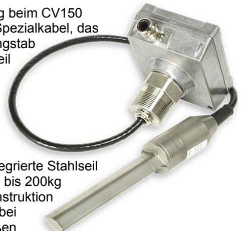
Das im Kabel integrierte Stahlseil hält Belastungen bis 200kg stand. Diese Konstruktion ermöglicht auch bei Geräten mit großen Einbaulängen einen einfachen Transport in kompakten Boxen. Der Einbau erfolgt von oben über ein Gewinde 1 ½" DIN2999 (entspricht BSPT) oder NPT.
